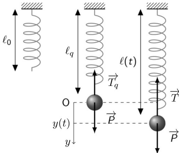
L'allongement du ressort en fonction du temps  $y(t)$ , est calculé par rapport à la position d'équilibre O.
